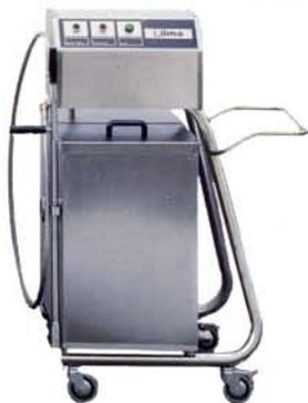
Pompa carrellata per il travaso dell'olio delle vasche di frittura con: serbatoio ispezionabile della capacità utile di 160 litri, filtro di separazione residui, comandi a bassa tensione, potenza installata kW 0,55 230/400.3.50+T, temperatura massima di lavoro 180°, dimensioni 700x870x1260 (h.) mm.
